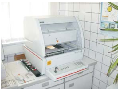
Bild 1 : Schichtdickenmessenrichtung nach der Röntgenfluoreszenzmethode
