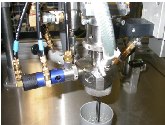
Bild 4: Dosiereinheit mit Mischkammer und Ventilen
